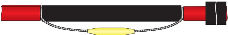
**Шаг 14.** Размягчить стержень термоплавкого клея в струе горячего воздуха и нанести по периметру оболочек всех 3-х нагревательных лент.
