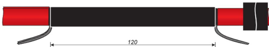
**Шаг 11.** Завести экранный жгут одиночного кабеля в гильзу 6,0-10,0 мм<sup>2</sup> и обжать кримпером. Надвинуть на экранный жгут термоусаживаемую трубку Ø8 мм длиной 40 мм.
