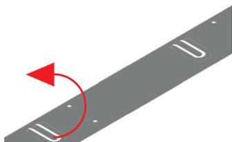
Закрепите монтажную ленту в необходимом месте. Для крепления используется кровельный саморез, вытяжная заклепка или двухсторонняя битумная липкая лента. Поднимите средние язычки на ленте.
